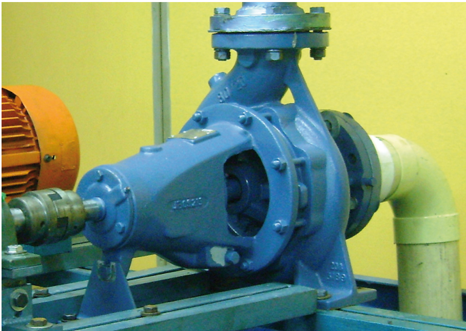
[Figura 21] Bomba Halberg NOWA, tipo 8020, 4*3*8.
