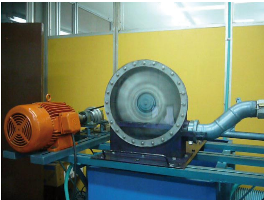
[Figura 11] Turbina Pelton acoplada a un generador asíncrono.
